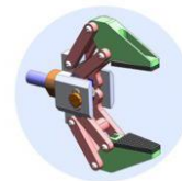
Simulation des mouvements d'une pince robot avec Edrawing
